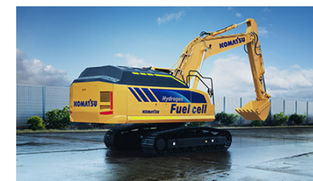
水素燃料電池を搭載した中型油圧ショベルのコンセプトマシン
