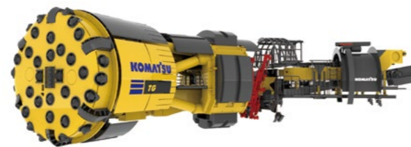
マイニングTBMは、No Blasting(発破の必要がない掘削)、No Batch(バッチ処理を行わない連続掘削)、No Diesel(ディーゼル不使用)のスローガンを掲げて開発
