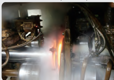
高周波焼き入れ[ロッド] Induction hardening (rod)
